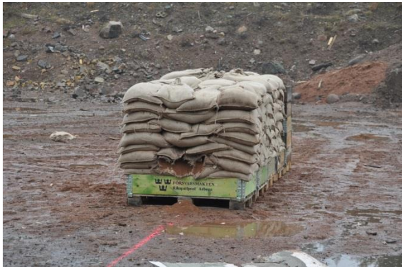
Figur 2-14 Sandsäcksbarriären efter träff (Skott 3:3).
