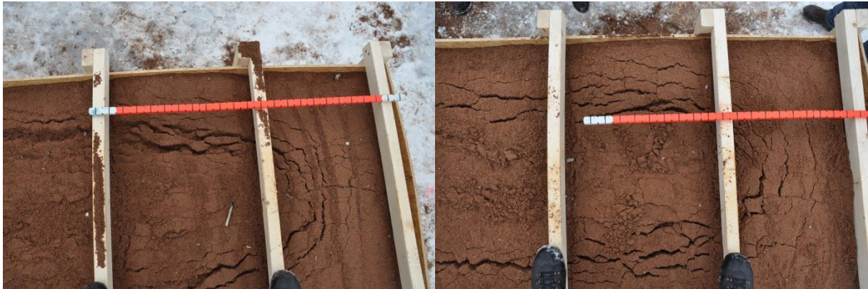
Figur 6-6 Grusbädden sjunker ihop efter RSV-strålens penetration, sannolikt relaterat till fas 3-penetration i målmaterialet, t.v. skott 1:2 och t.h. skott 1:5.
