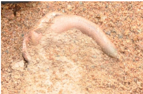
Figur 2-12 Lokaliserat sluggsegment i sandbädd 2 (Skott 2:3).
