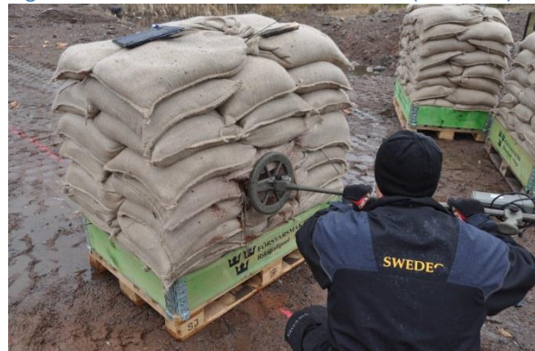
Figur 2-17 Sluggsegmentets lokaliseras med metalldetektor innan friläggning genomfördes (Skott 3:2).
