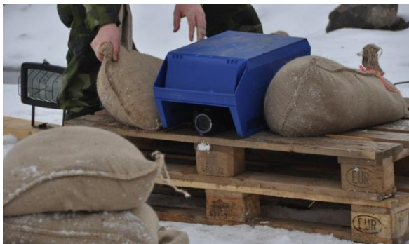
Figur 1-10 Höghastighetskameran skyddades mot splitter med sandsäckar. Halogenbelysning användes för att erhålla bättre ljusförhållanden för filmning.
