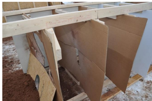
Figur 2-10 Vittnesskivor efter skott (Skott 2:3).
