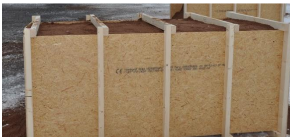
Figur 1-2 Konstruktion mål, regelförstärkt trälåda.
