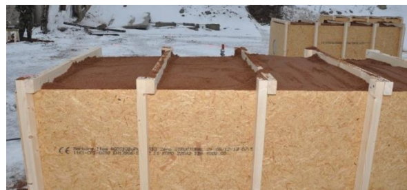
Figur 1-3 Målkonstruktion med sandfyllning packad genom trampning.
