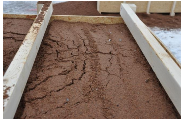
Figur 2-2 Sättningar i sandbädden efter strålens penetration (Skott 1:3).
