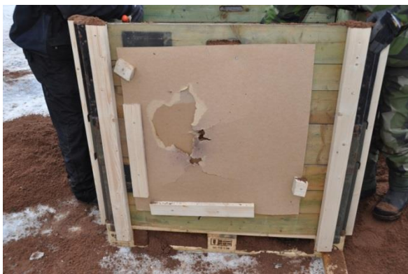
Figur 2-9 Sandbädd 2 efter skott (Skott 2:3).
