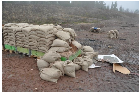
Figur 2-15 Sandsäcksbarriären efter träff (Skott 3:2).
