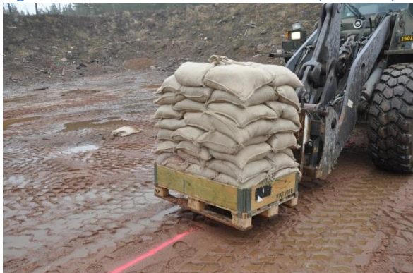
Figur 2-16 Sandsäcksbarriären delades maskinellt för att lokalisera penetrerade moduler (Skott 3:3).
