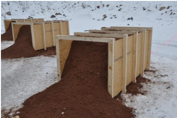
Figur 2-1 Målkonstruktionens utseende efter skott (Skott 1:3).
