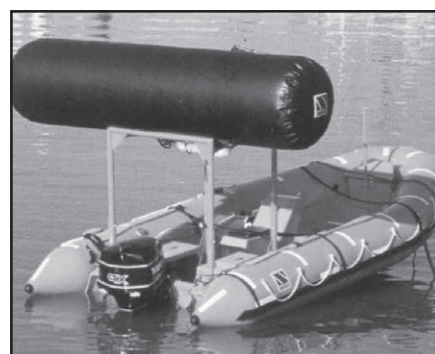
Här en upprättningsballong på en Zodiac från Uni-Safe i Danmark, men principen är lika oavsett fabrikat.
