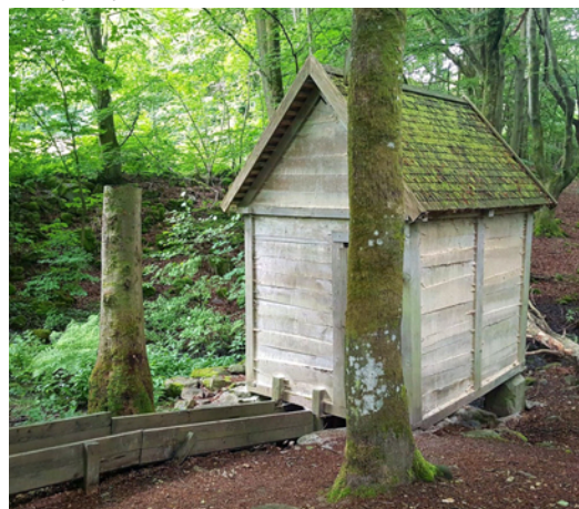
(fig. 16) En nybyggd skvaltkvarn av äldre modell visar hur det såg ut på 1700-talet och förmodligen långt tidigare än så. Foto från fältbesök.
